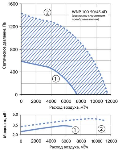
1 — характеристика на номинальных оборотах без использования частотного регулятора ( $n_{\text{nom}}=1435 \text{ мин}^{-1}$ )
