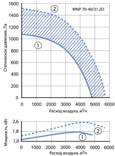
1 — характеристика на номинальных оборотах без использования частотного регулятора ( $n_{nom}=2840 \text{ мин}^{-1}$ )
