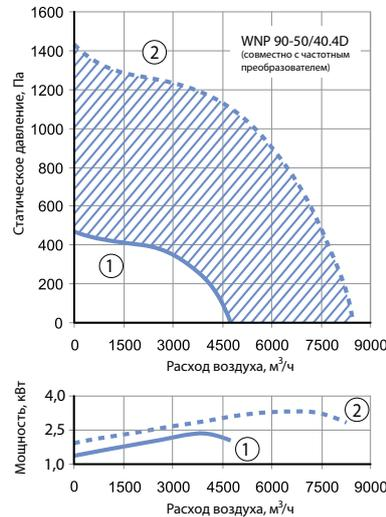
1 — характеристика на номинальных оборотах без использования частотного регулятора (n ном=1410 мин-1)
